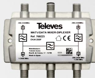
Este elemento passivo pode ser instalado em qualquer parte da instalação coaxial, para separar os sinais de TV terrestre e por satélite (290...2400 MHz), do sinal de dados (1...200 MHz), e poder geri-lo de forma independente (principalmente para amplificação).
